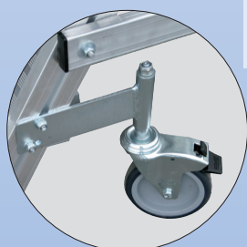
4 forgókerék (Ø=125 mm), mely használat közben automatikusan besüllyed, ebből 2 rögzítőfékkel rendelkezik
